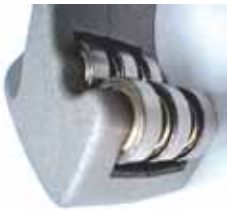
ⓓ Gleitrollen durch Kugellager
